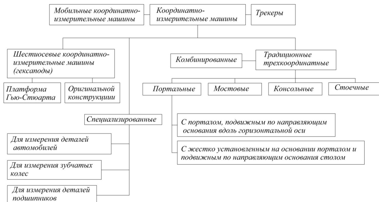
Рис. 1. Классификация современных координатно-измерительных машин
