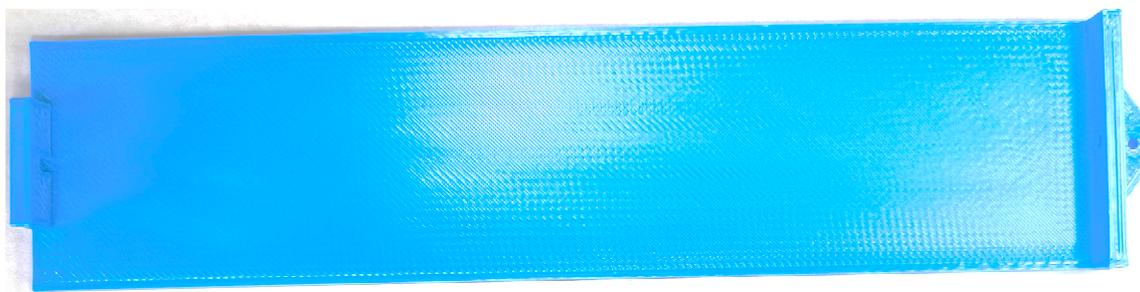
**Рисунок 2. Корпус динамометра, напечатанный на 3D-принтере Creality Ender 3 V3 SE**
