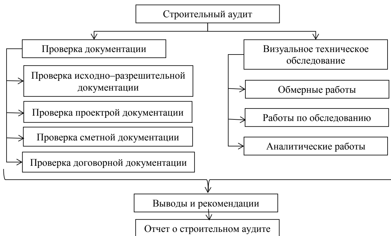
Рисунок 1 – Состав работ строительного аудита
