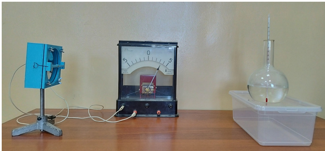
Рисунок 1. Схема установки для демонстрации теплового излучения нагретых тел
